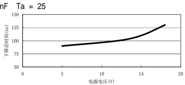
图表4 下降沿时间 vs 电源电压
