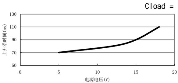
图表3 上升沿时间 vs 电源电压
